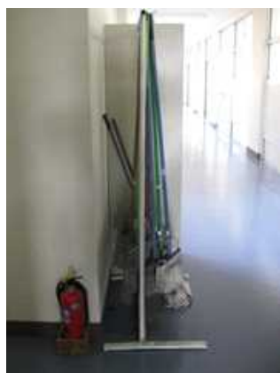
←写3 重心を後側にして前方に転倒しにくくしたモップ掛け
