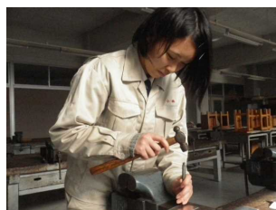
写4 ポンチ打ち作業
