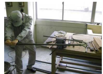
写3 パイプ曲げ
