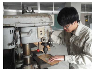
写5 ボール盤による穴あけ作業
