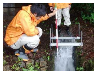
写 4 現地調査 (水位の計測)
