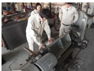
写2 シャーによるアルミ板の切断作業
