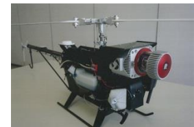
超小型航空レーザー スキャナー搭載型専 用無人航空機の開発
