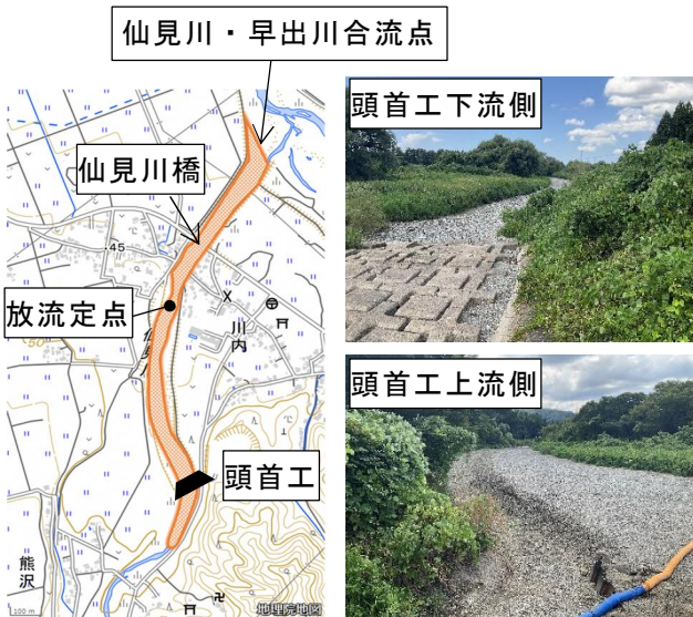
図 3 2023 年 8 月 19 日の渇水範囲（着色部）及び頭首工下流側と上流側の状況（地理院地図を加工して作成）
