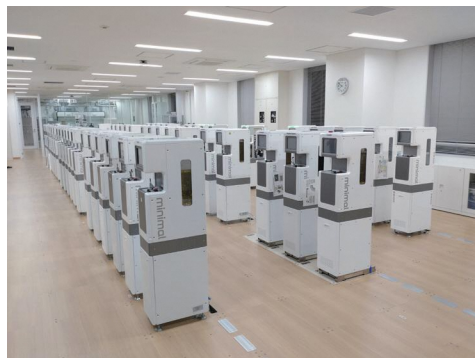
それぞれが異なる半導体プロセスに対応した「ミニマル装置」と呼ばれる個別装置（産業技術総合研究所臨海副都心センターに設置）
