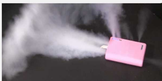
充電していたモバイルバッテリーからの発火の様子
