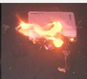
充電していたモバイルバッテリーからの発火の様子
