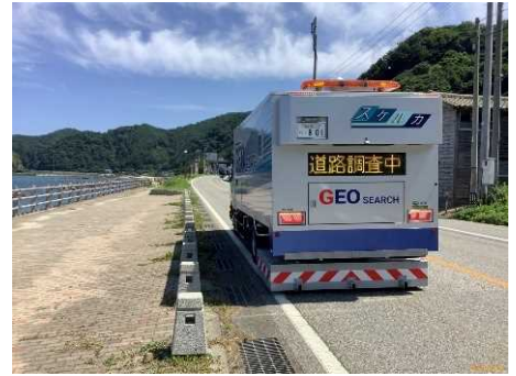
路面下空洞調査（県道部レーダー探査）
