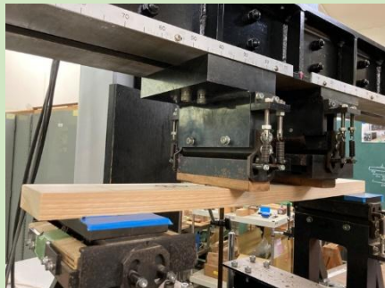
(大径材の強度試験)
