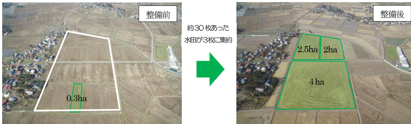
〈経営体育成基盤整備事業「高野地区」で整備した、県内最大規模の4haの大区画水田〉
