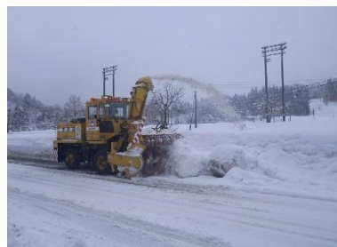
ロータリー除雪車による除雪
