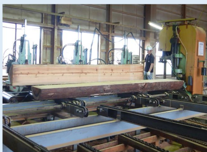
製材所で柱や梁など様々な材料に加工 木材は建築や燃料等に利用されます
