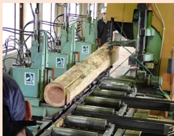
製材所で柱や梁など様々な材料に加工 木材は建築や燃料等に利用されます
