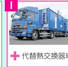
残留熱除去設備 (各号機3台)
