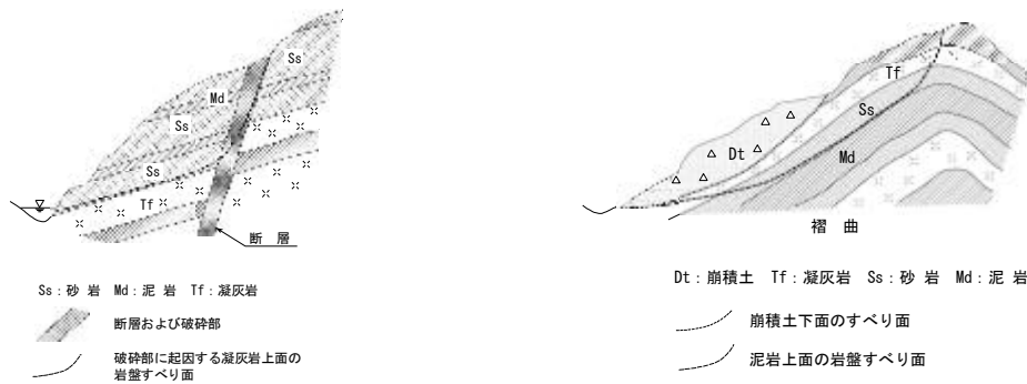
(a) 単斜構造（流れ盤）、断層に起因する地すべりのモデル (b) 褶曲（背斜構造）に起因する地すべりのモデル
