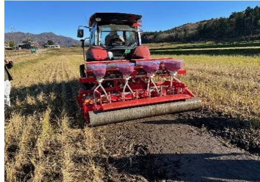
<スリップローラーシーダーによる乾田初冬直播>
