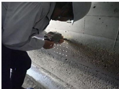
< 機能診断（コンクリートの健全度測定） >
