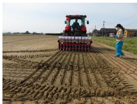
< 自動操舵トラクタによる V 溝直播 ( 新潟市・燕市打越地区 ) >
