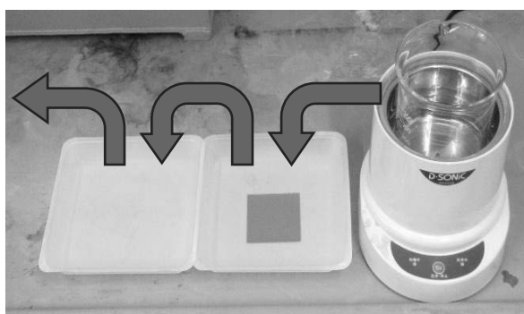
中和 ← 水洗 ← 混合酸洗浄 (アルカリ電解水) (水道水) (超音波照射) 図2 混合酸による洗浄実験の様子
