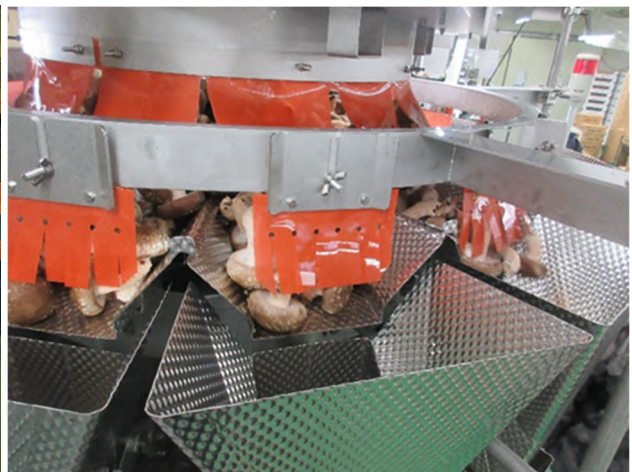
全自動計量機による作業の省力化
