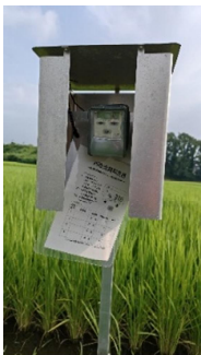
図 2 刈取適期判定器（積算温度計）
