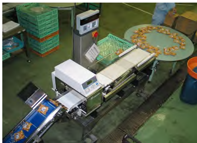
きのこ生産施設で異物の混入を防ぐ金属検出器
