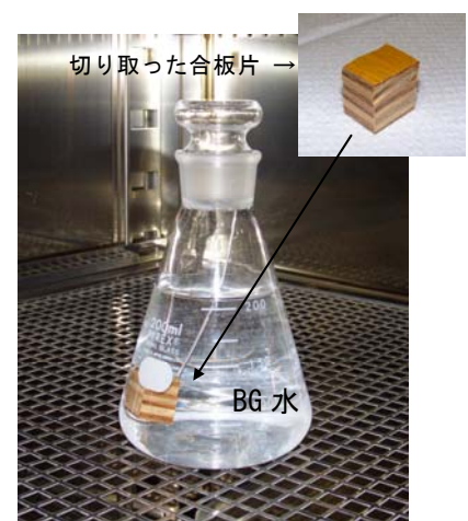
Fig.1 合板からのトリチウムの抽出法
