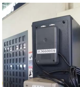
光センサのデータを取得し、無線でデータを送信するための機器
