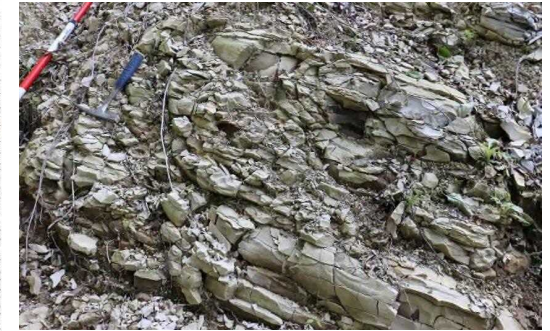
写真③ スレーキングで岩片化した岩盤上部の風化部
