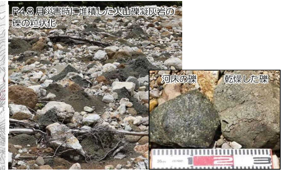
写真② 風化により粒状化した火山礫凝灰岩の礫
