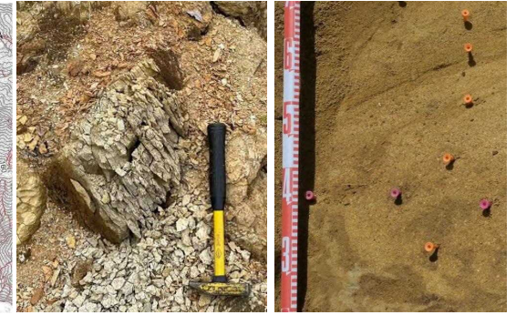
写真③ 泥岩のスレーキング 写真④ 砂岩のサブロライト
