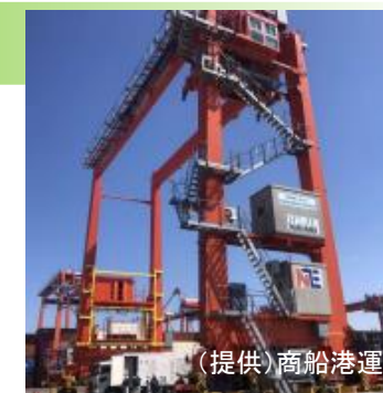
水素燃料電池型RTG(横浜港) 水素エンジン発電機型RTG(神戸港)
