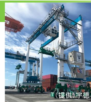
水素燃料電池型RTG(横浜港) 水素エンジン発電機型RTG(神戸港)
