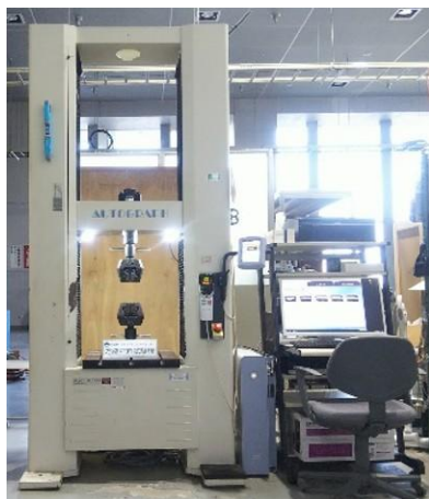
(株)島津製作所 オートグラフ AG100kN (毎年、JCSS校正を実施)
